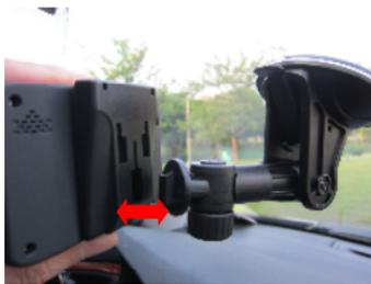
3. デバイスを固定する際に、内蔵の3軸加速度センサーを精度をより高いものにするためには、LT-Q6000が垂直状態を維持するようにしてください。
